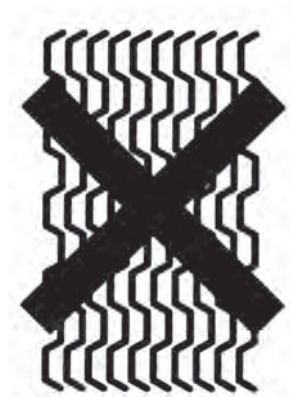
Рисунок В.6 – Вид пакета пластин при неправильной сборке
